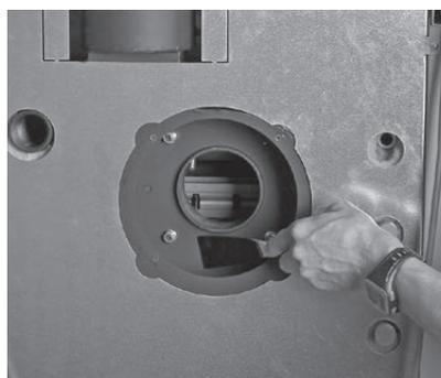
Fig. 60 Pulire l'interno della scatola del ventilatore
