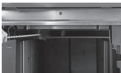
Fig. 56 Pulire l'aspirazione del gas distillato a bassa temperatura
